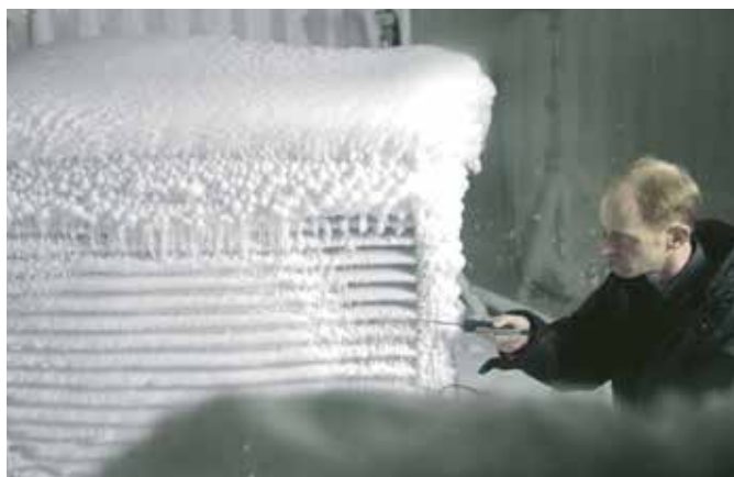
I kølerummet testes varmepumperne under ekstreme temperaturer.
